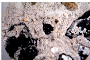
Microscope stéréoscopique en lumière naturelle : placage d'un gel d'alcali-réaction (en blanc) sur un granulats calcaire (en noir) (IFSTTAR)
