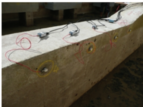
Suivi de l'endommagement d'une poutre précontrainte suivant la force appliquée durant l'essai à l'effort tranchant (rond rouge : capteur EA, rectangle bleu : renfort composite, ligne verte/rose : câble de précontrainte)
