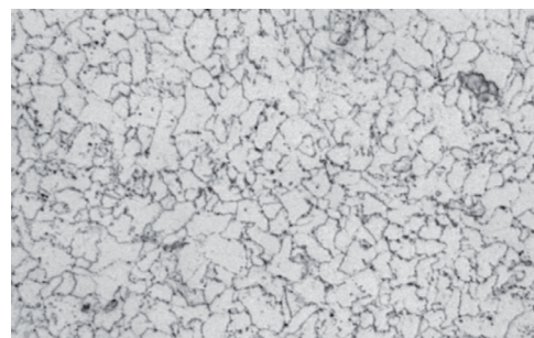
Réplique : détail de la photo de gauche (grossissement x1000) - Source : Institut de Soudure
