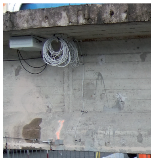
Photo 2 : Raccordement des capteurs à un conditionneur sans-fil (boîtier PEGASE) (Cerema)
