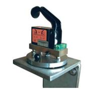
Inclinomètre électrique à alimentation autonome disposé sur une embase (Photo: Huggenberger)
