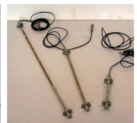
Corde vibrante sans raideur à excitation répartie (IFSTTAR)
