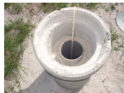
Exemple de piézomètre où la mesure du niveau piézométrique est faite à l'aide d'une sonde manuelle (Portail National ADES)
