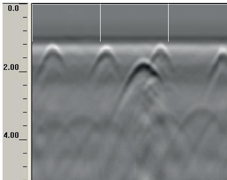
Figure 4 : Câble de précontrainte détecté par radar sous une nappe d'armatures passives (en x déplacement de l'antenne (cm) et en y temps d'écoute (ns)). (Cerema)
