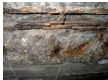
Prélèvement de fils effectué sur ce câble corrodé (Cerema)
