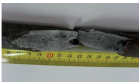
Fil prélevé au droit d'une rupture (Cerema)
