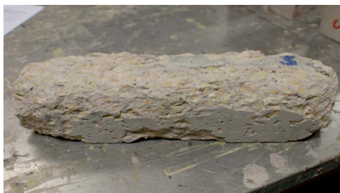
Éprouvette fortement dégradée à l'issue d'un essai de gel (CEREMA)
