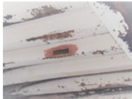
Prélèvement d'un échantillon de taille réduite dans un auget de dalle orthotrope (SOCOTEC)
