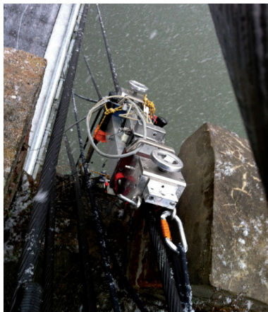
Dispositif en position sur un câble de pont haubané (Cerema)
