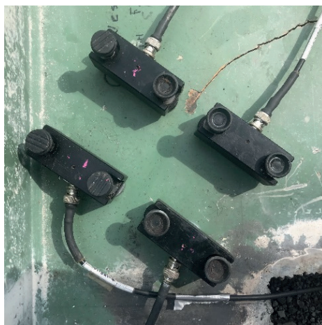
Réseau de capteurs d'émission acoustique mis en place au niveau d'une fissure de fatigue existante sur un ouvrage d'art [HAY 2021]
