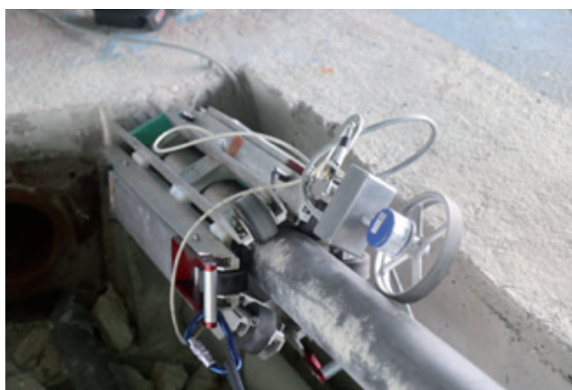
Exemple de dispositif d'auscultation avec roue codeuse en position sur un câble (Cerema)
